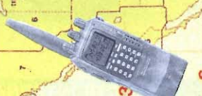
IC-W21 e IC W21ET - Bibanda palmare 5W VHF 144-148 MHz (Rx) 136-174 MHz (Tx) UHF 430-440 MHz
