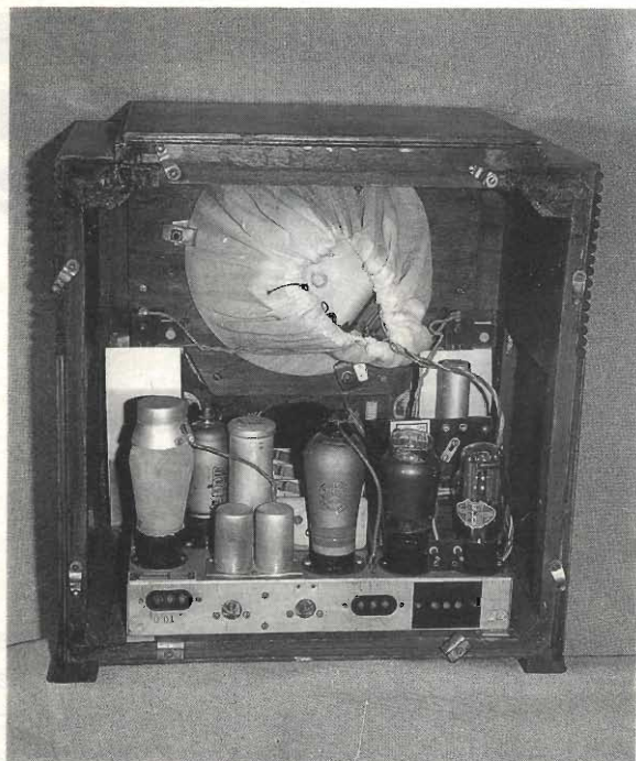
Vista posteriore dell'apparato. Notare la cuffia di protezione dell'altoparlante.
